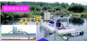
清淤建议采取“精准清淤”方法，即至清除底泥表层30cm以上的沉积物。德国所谓“生态清淤”由机器人控制，可达到精准清淤
