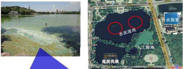
2012年8月-2013年5月采用底泥洗脱、补水净化和表流湿地构建三项技术, 4个月后南小湖水体变清, 六个月后沉水植物自然生长, 8个月底栖植被形成。
